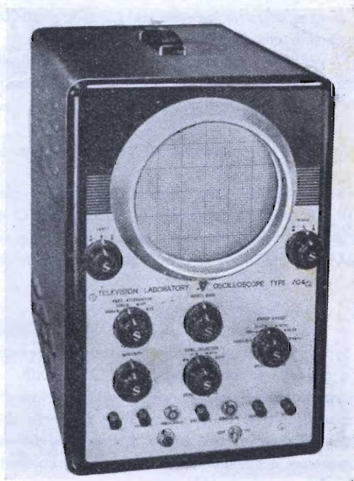
Fig. 2.22 - Aspetto esterno dell'oscilloscopio Sylvania mod. 404.
