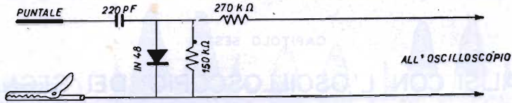
Fig. 6.1 - Probe per l'esame dei segnali AF e MF.
