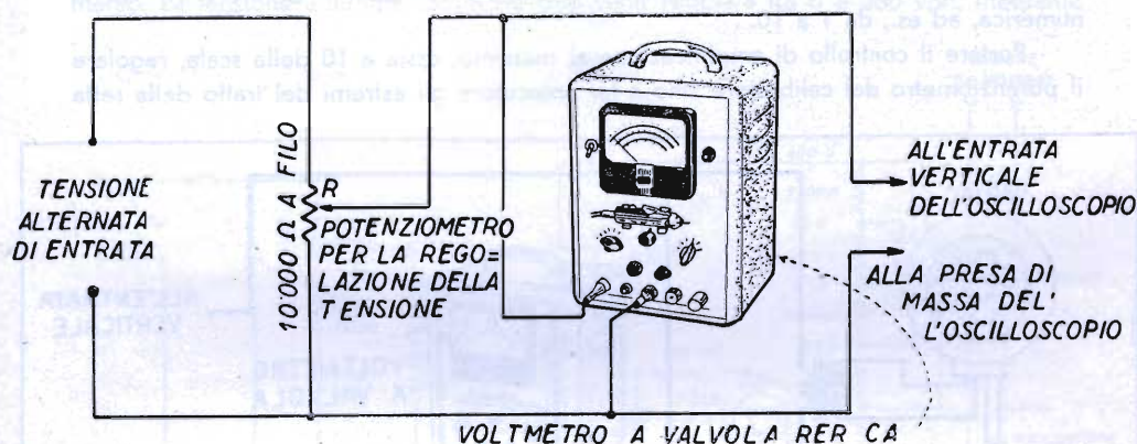
Fig. 4.6. - Disposizione per la calibrazione dell'oscilloscopio con voltmetro a valvola.
